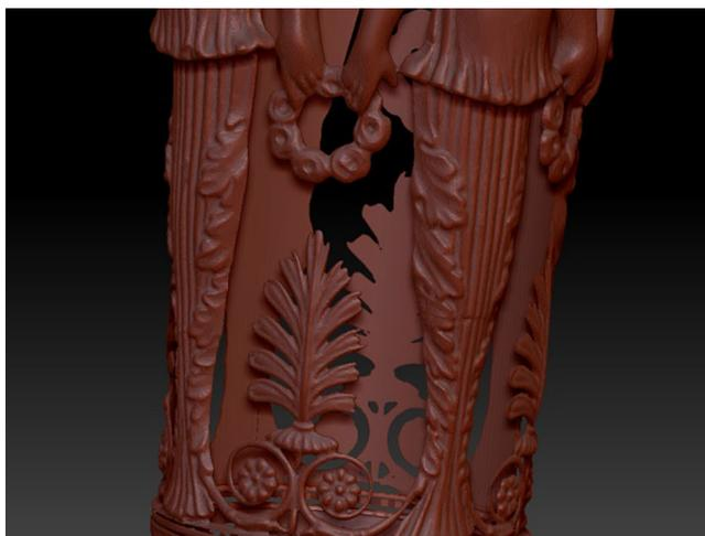
Abbildung 77: Ansicht nach Subtraktion des Drehkörpers vom Scanmodell in ZBrush / Screenshot: Deutsches Museum Digital, CC BY-SA 4.0
