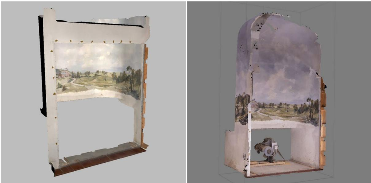
Abbildung 73: Scan-Ergebnis Streifenlichtscan mit Artec Leo (links), Photogrammetrie mit Agisoft Metashape (rechts), Screenshots: Deutsches Museum Digital, CC BY-SA 4.0
