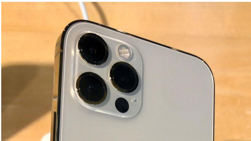
Abbildung 6: Kamera-Array des iPhone12 Pro mit LIDAR-Kamera (unten rechts), Quelle: Wikimedia, CC SA 4.0, Autor: KKPCW
