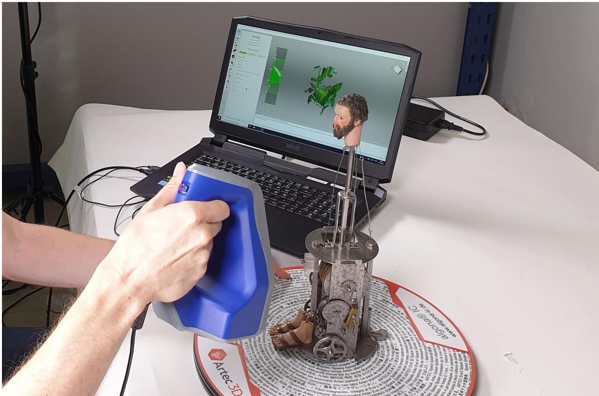
Abbildung 14: Handgeführter Streifenlichtscanner, Foto: Deutsches Museum Digital, CC BY-SA 4.0
