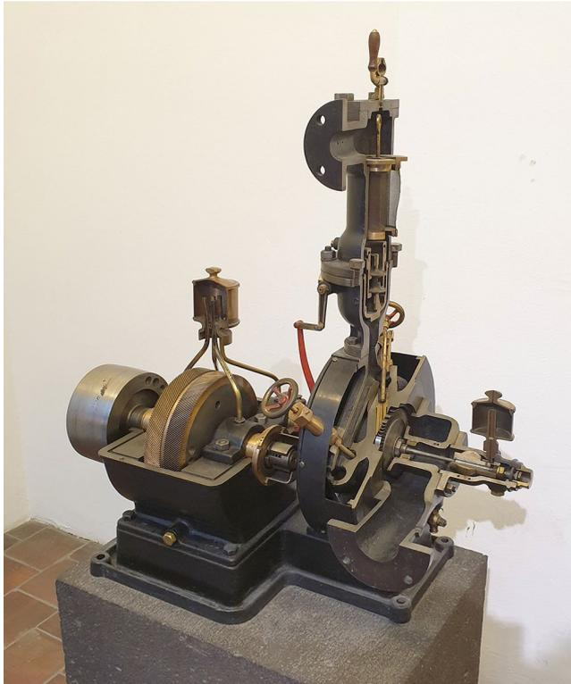
Abbildung 41: Gleichdruck-Dampfturbine, Foto: Deutsches Museum Digital, CC BY-SA 4.0
