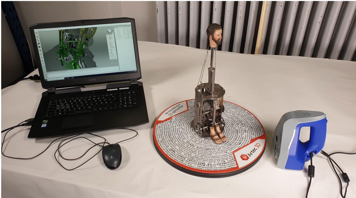
Abbildung 26: Predigender Mönch gescannt mit Artec Space Spider, Foto: Deutsches Museum Digital, CC BY-SA 4.0
