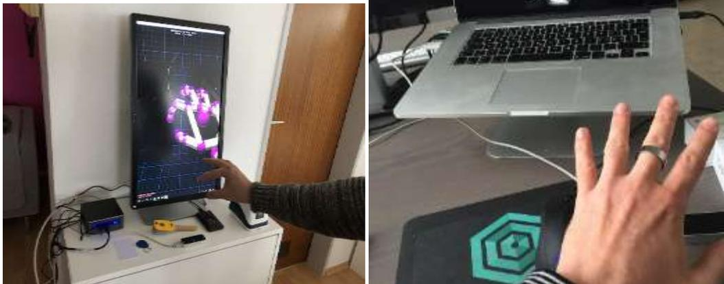
Links erkennt man einen ersten Prototyp für eine Station, die sowohl mit QR-Codes, als auch über NFC (in der Rassel unten im Bild) aktiviert werden konnte. Auch dieses Verfahren ist zuverlässig, aber benötigt aktive Interaktion. Aus diesem Grund haben wir uns für die Variante der iBeacons in 3D-gedruckten Masken entschieden.
