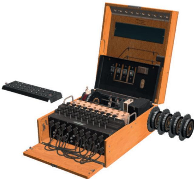
Abb. 4: Explosionsdarstellung Enigma M4, 1944
